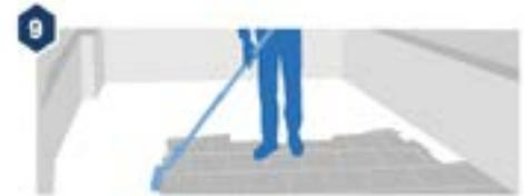
9 Aplicar una nueva mano de TKROM ANTIGOTERAS o TKROM CUBIERTAS para cubrir perfectamente la malla de fibra de vidrio.
