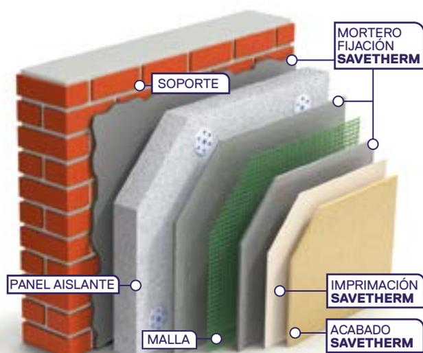
DISPONIBLES TODOS LOS COMPONENTES MECÁNICOS NECESARIOS PARA SU CORRECTA INSTALACIÓN: TACOS, PERFILERÍAM PLANCHAS EPS, MALLA DE FIBRA DE VIDRIO.
