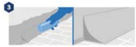
3 Realizar media caña con TKROM ANTIGOTERAS o TKROM CUBIERTAS y arena de cuarzo de 0,4mm (2:1 en volúmen).
