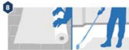
8 TKROM ANTIGOTERAS o TKROM CUBIERTAS + malla de fibra de vidrio para terrazas 60gr/m<sup>2</sup>.
