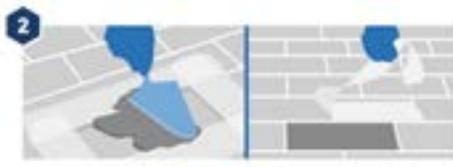
2 Reparar las zonas deterioradas con mortero TKROMPLAST EXTERIOR-152.
