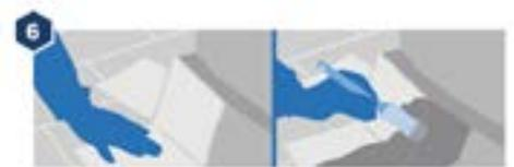
6 Realizar media caña con TKROM ANTIGOTERAS o TKROM CUBIERTAS y arena de cuarzo de 0,4mm (2:1 en volúmen).
